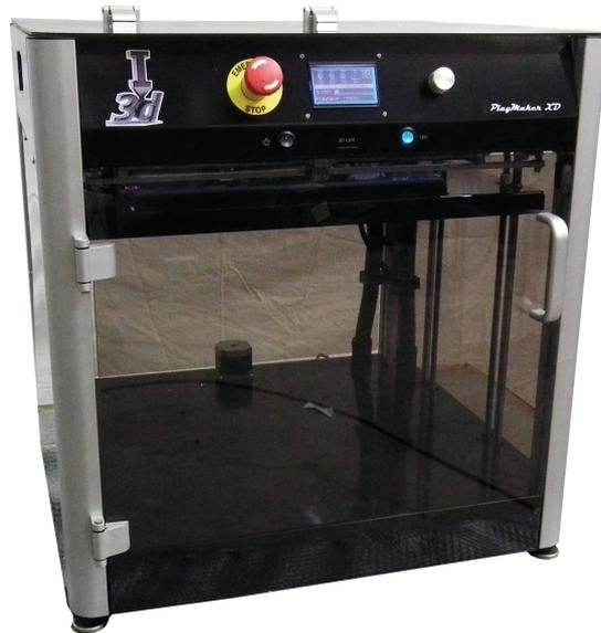
PlayMaker XD, stampante 3D di terza generazione, utilizza la tecnologia FFF (fused Filament Fabrication).
