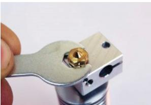
L'ugello in ottone dal diametro standard di 0,40 mm è intercambiabile con il semplice ausilio di una chiave di 7 mm.
